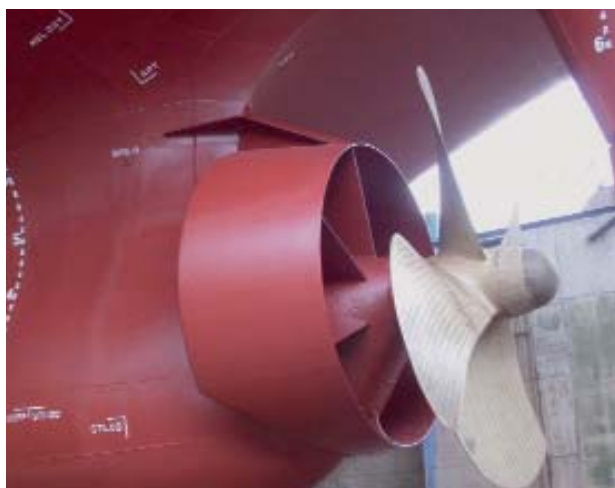
Schraube des MS »CONTI ARAGONIT« mit "Becker Mewis Duct"
